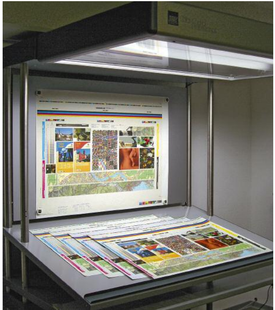
Die Colorstation mit Normlicht (5000 Kelvin).
