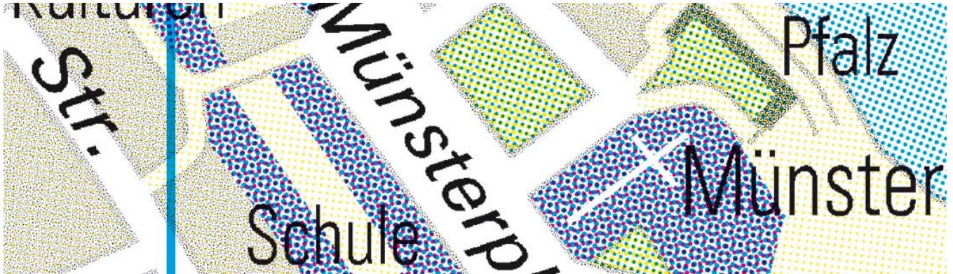
Abb. 16 AM-stochastischer Raster für Strassenkonturen und Siedlungsflächen im Schwarzauszug, zur Vermeidung von Objektmoiré. Konventionelle AM-Raster mit 60 P/cm in den Buntfarbenauszügen. Ausschnitt Stadtplan Basel 1 : 15 000, stark vergrößert. © 2004 Orell Füssli Kartographie AG, Zürich. Bewilligung der Kantonalen Vermessungsämter BS, BL und AG.
