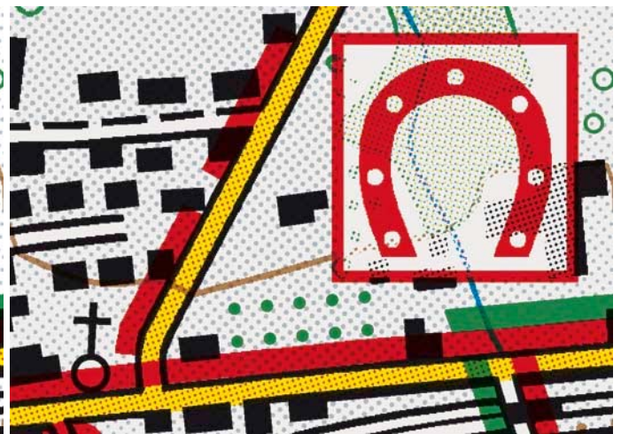
Abb. 9 Farbverbindlicher Proof/Rasterproof mit Rendering Intent: farbmetrisch ABSOLUT, Weisspunkt: mit Absicht übertrieben dunkel.
