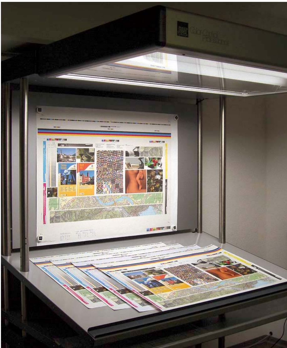
Abb. 21 Betrachtungsstation mit D50-Normlicht, Betrachtungsfläche von etwa 150 x 100 cm. CMYK-Referenzform (mit ECI2002-Testchart, jeweils in der Mitte) auf verschiedenen Papieren gedruckt (liegend) und Proof (hängend).
